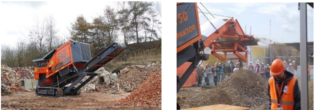
Slika 14.3-2. Mašina/postrojenje za tretman otpada od građenja i rušenja, (drobilica, magnetni separator - slika levo i sito na kraju konvejera (slika desno)
