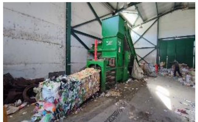
Slika 6.1-5. Horizontalne poluautomatske prese (levo) i automatska presa za baliranje otpada (desno)
