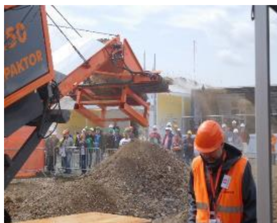
Слика 14.3-2. Машина/постројење за третман отпада од грађења и рушења, (дробилица, магнетни сепаратор - слика лево и сито на крају конвејера (слика десно)
