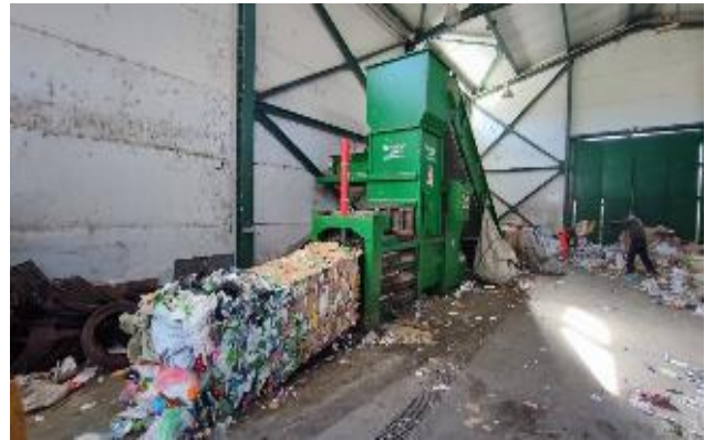
Слика 6.1-5. Хоризонталне полуаутоматске пресе (лево) и аутоматска преса за балирање отпада (десно)
