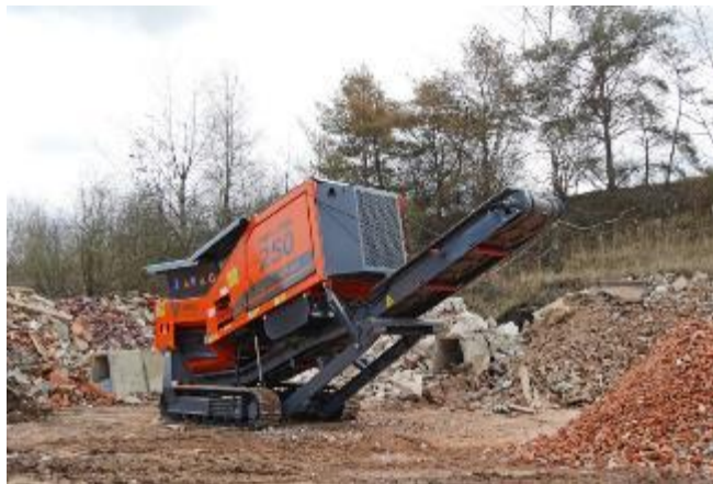
Слика 14.3-2. Машина/постројење за третман отпада од грађења и рушења, (дробилица, магнетни сепаратор - слика лево и сито на крају конвејера (слика десно)
